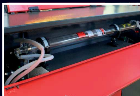
Vodou chlazená laserová trubice
