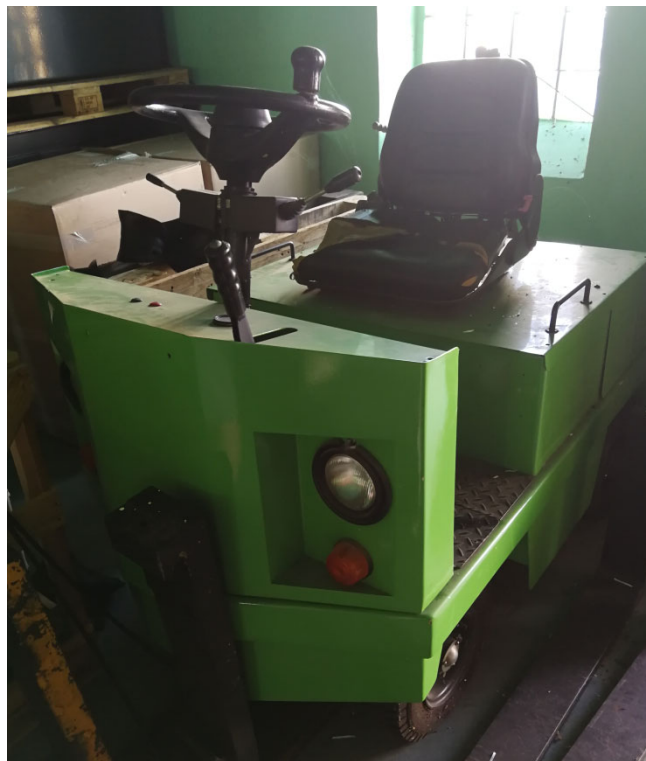
Obr. 2 - Tahač Balkancar, zelený, ET512, elektrický pohon (akumulátor), bez štítku
