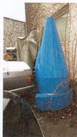
Pozn. znalce. Zařízení sepsané v MP a dle insolvenčního správce určené pro filtrace vody, zařízení tvaru kuželes, modré barvy, ocelové konstrukce, je dle znaků dostupných při běžné prohlídce (pouze na základě vnějších znaků) zařízením používaným pro odlučování drobné prachové částice v plynných produktech, tzv.
