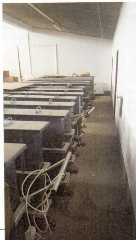
Zařízení je koncipováno modulově a je umístěné na mobilní ocelové konstrukci a umožňuje tak sanitaci podlahové plochy. Každé zařízení se skládá ze dvou rovnoběžně umístěných nádrží. V uličce mezi každou nádrží jsou umístěny patice pro dvě výbojky (230V), pro dvojici zařízení sloužilo jedno vzduchovadlo výrobce Oase, typ AquaOxy 4800.
