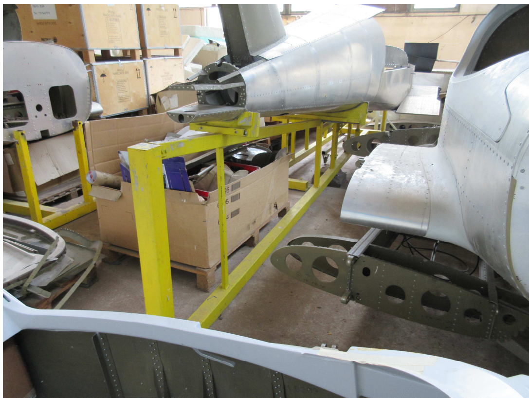
Obrázek 29: Přípravky na upevnění trupu
