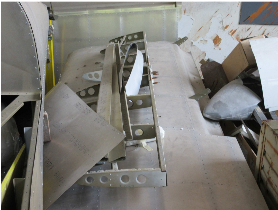
Obrázek 27: Stabilizátor rozpracovaný, nedokončený
